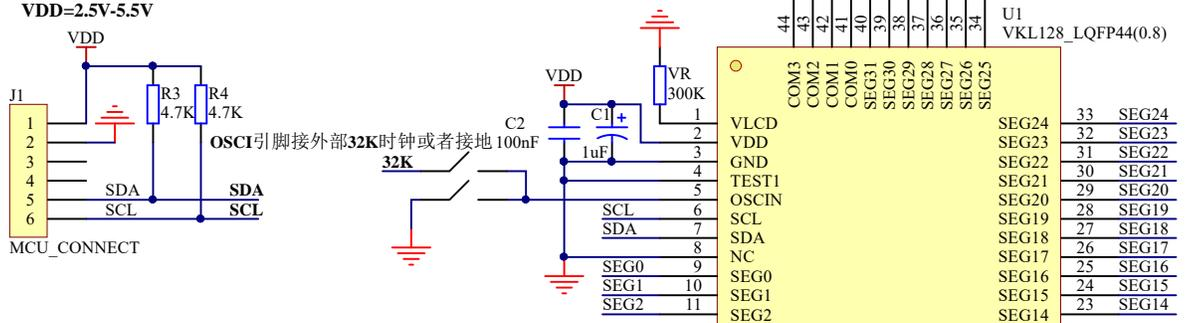
建议芯片的COM脚和LCD的COM脚顺序1对1连接
